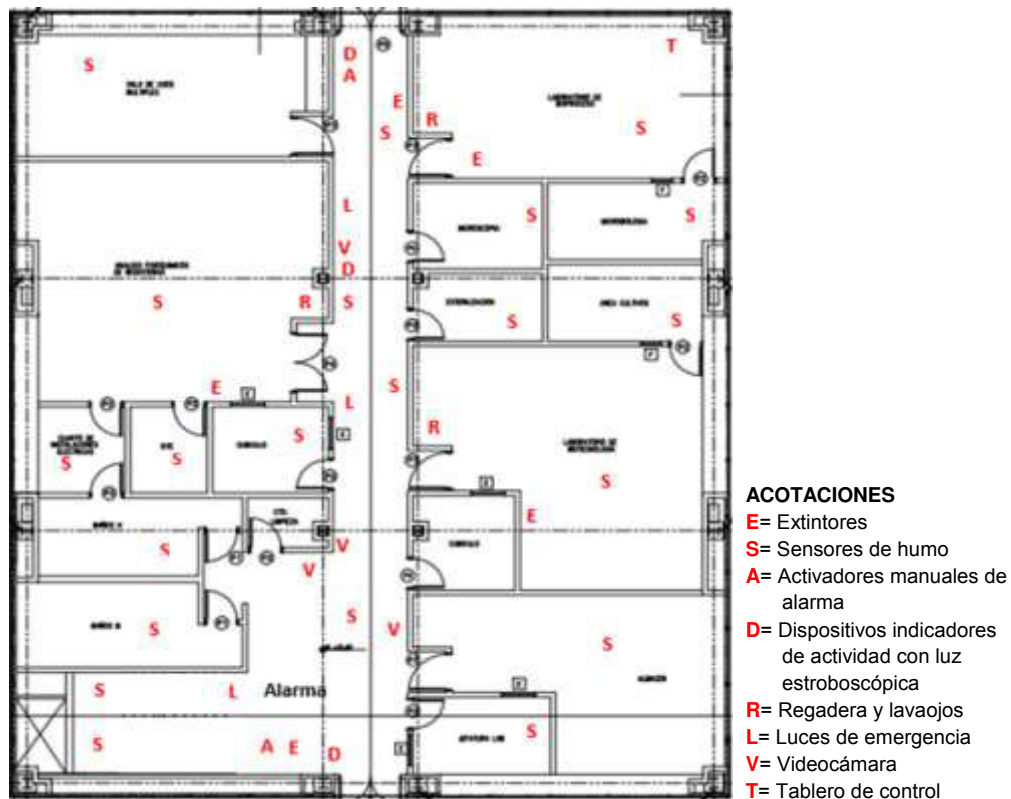
Figura 4. Sistema de Alarmas y elementos de seguridad en el Laboratorio
