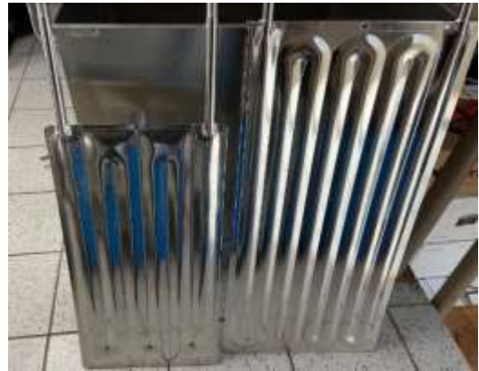
Figura 11. Sistema de refrigeración para el proceso de fermentación con placas de enfriamiento
