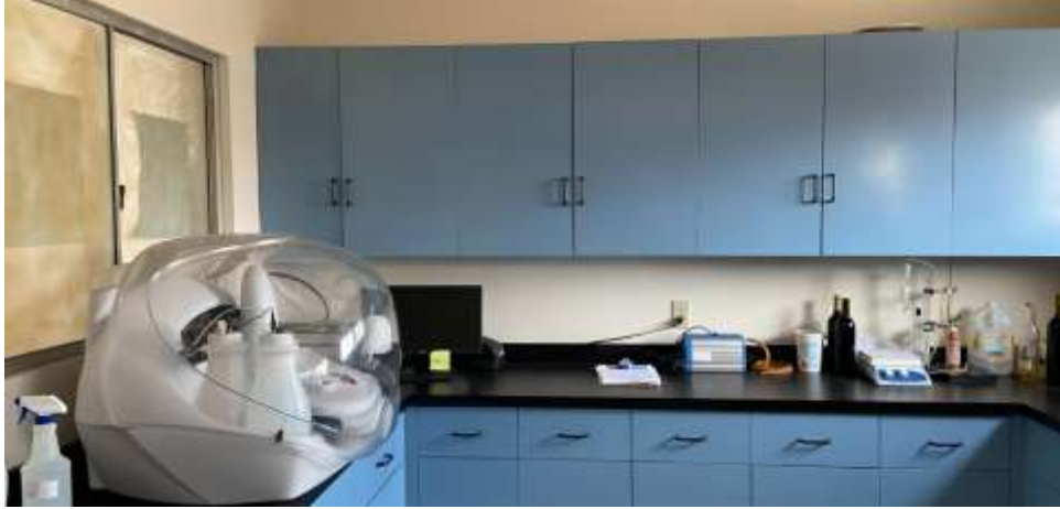
Figura 15. Equipo Biosyste para determinar análisis químicos en Mostos y Vinos
