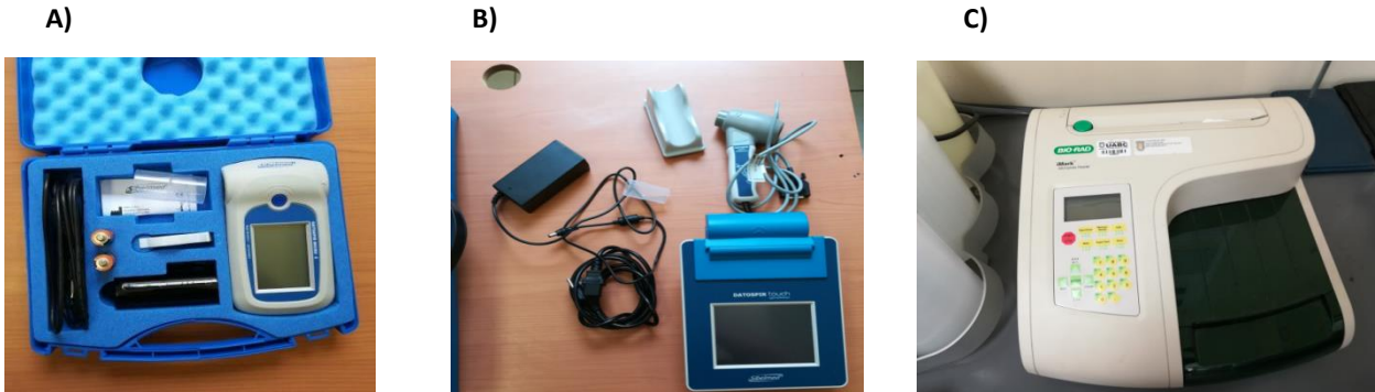
Figura 4. Equipo de evaluación clínica. A) y B) Espirometros. C) Lector de ELISA. Fuente: Elaboración propia
